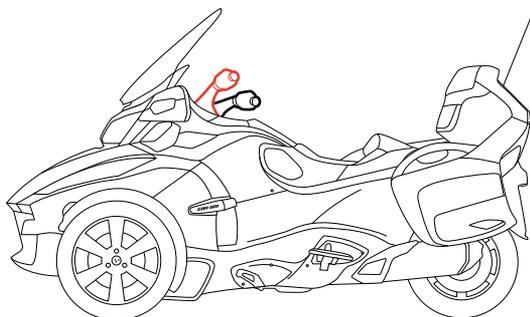
RÉGLAGE DU GUIDON SELON TROIS AXES, EN HAUTEUR, EN LARGEUR ET VERS L'AVANT OU L'ARRIÈRE.
