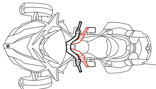
LES PARTIES GAUCHE ET DROITE DU GUIDON SONT LIÉES L'UNE À L'AUTRE ET TOURNENT SIMULTANÉMENT LORS DU RÉGLAGE.
